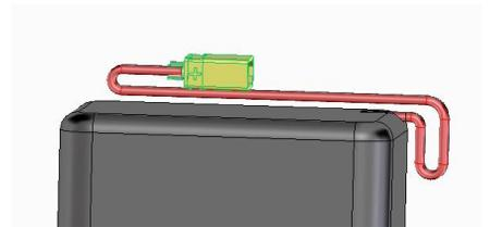
Attention, afin de diminuer le risque de pincement du fil entre le couvercle et le boîtier lors de la fermeture et donc mettre l'étanchéité en péril, veuillez positionner le fil de la batterie comme ceci :
