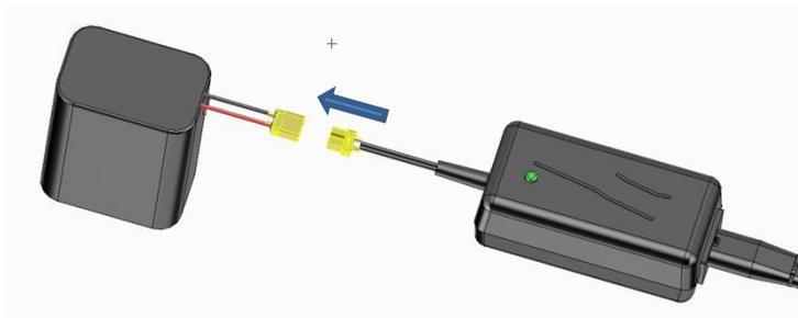
Connecter la batterie au chargeur grâce aux connecteurs prévus à cet usage. Le connecteur contient un détrompeur pour éviter les inversions de polarité.
