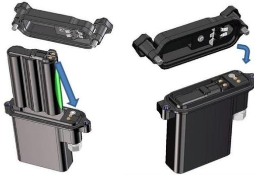
Positionner les pins de contact de la batterie du même côté que celles du boîtier contenant la batterie. Puis refermer le couvercle en vous assurant que le joint est propre pour assurer l'étanchéité. Visser les 2 vis jusqu'à ce que le couvercle soit bien plaqué sur le boîtier.
