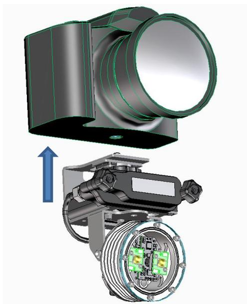
Présenter l'éclairage sous l'appareil. Celui-ci se fixe via une vis ¼ UNC.
